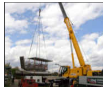
Ein Autokran hievte den 2,8 Tonnen schweren Solarkatamaran vom Tieflader auf den Bostalsee. Foto: pdk
